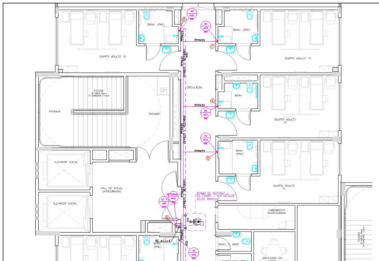
Figura 16 - BARRILETE 4º PAVIMENTO - Pontos 4 ao 8 selecionados. Fonte: Do autor.
